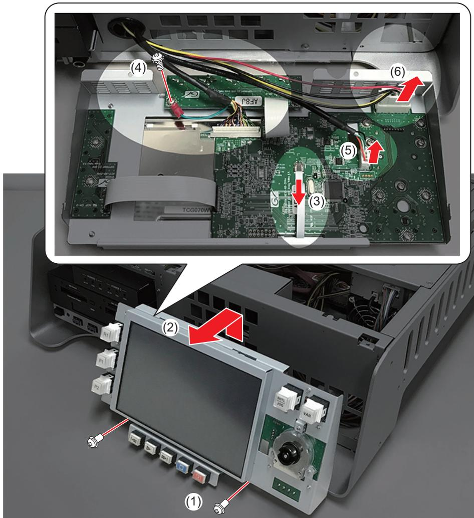
**POINT :** ボタンキットが取り付けられているタッチスクリーン LCD を T2 に取り付ける際は、ボタンキットの左右の突起部分をT2側のa部分に差し込むようにしてください。
